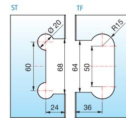
Glasbearbeitung für 8 mm mit Dichtprofil 8857KU0-8-2010
