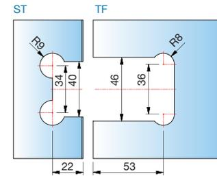
Glasbearbeitung für 8 mm ohne Dichtprofil
