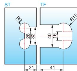
Glasbearbeitung für 8 mm mit Dichtprofil 8857KU0-8-2010
