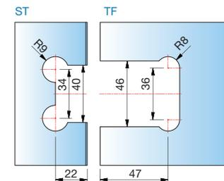
Glasbearbeitung für 8 mm mit Dichtprofil 8861KU0-8-2010
