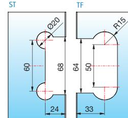
Glasbearbeitung für 8 mm mit Dichtprofil 8861KU0-8-2010
