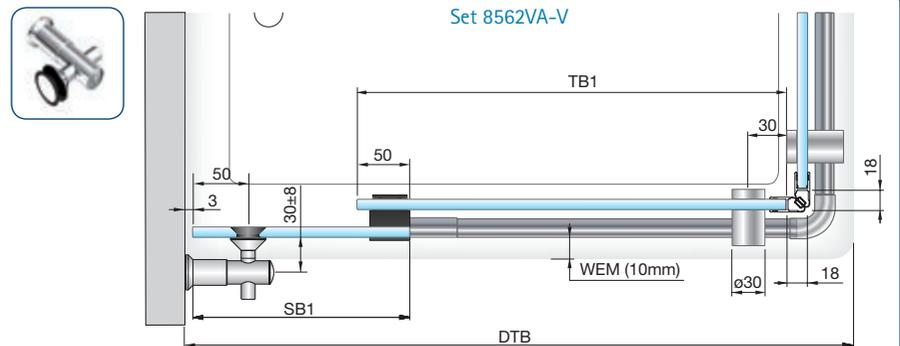
Set 8562VA-900: Einfachlaufrohr, Eckdusche, Wandhalter flächenbündig, für Duschtasse 900 x 900 mm
