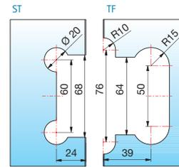
Glasbearbeitung für 8 mm ohne Dichtprofil
