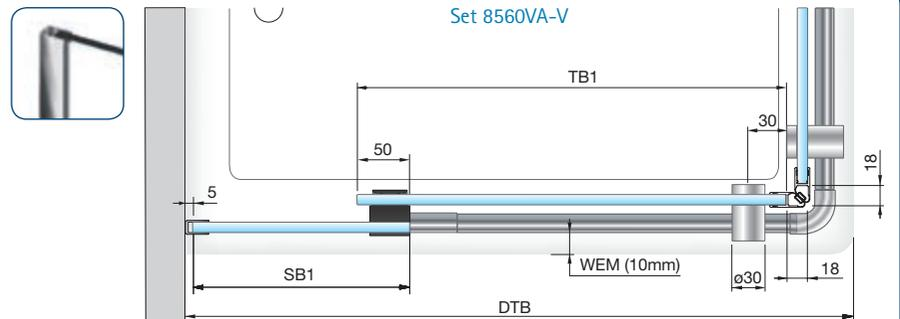
Set 8560VA-900: Einfachlaufrohr, Eckdusche, U-Profil, für Duschtasse 900 x 900 mm
