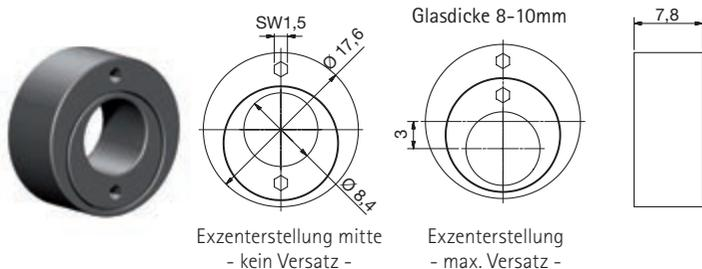
Exzenterstellung frei wählbar, Verstellung mittels Innensechskantschlüssel SW1,5mm
