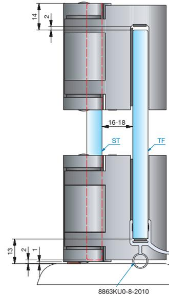
Verstellbereich für den Türflügel bei den unterschiedlichen Überlappungen (Ü). Die Mindestüberlappung sollte nicht unterschritten werden.
