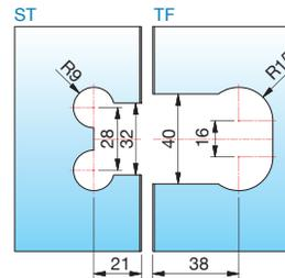
Glasbearbeitung für 8 mm mit Dichtprofil 8861KU0-8-2010
