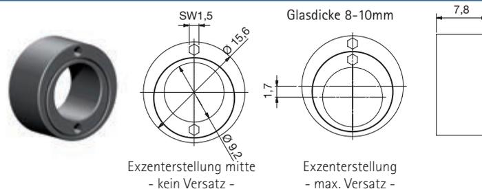
Winkel frei wählbar, Verstellung mittels Innensechskantschlüssel SW1,5mm
