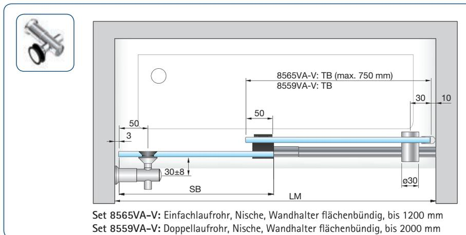
$$DM = (LM + (20 \text{ mm} - \text{Dichtprofil})) / 2 - 80 \text{ mm}$$
