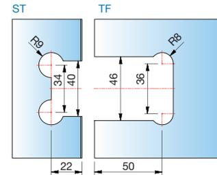
Glasbearbeitung für 8 mm mit Dichtprofil 8857KU0-8-2010
