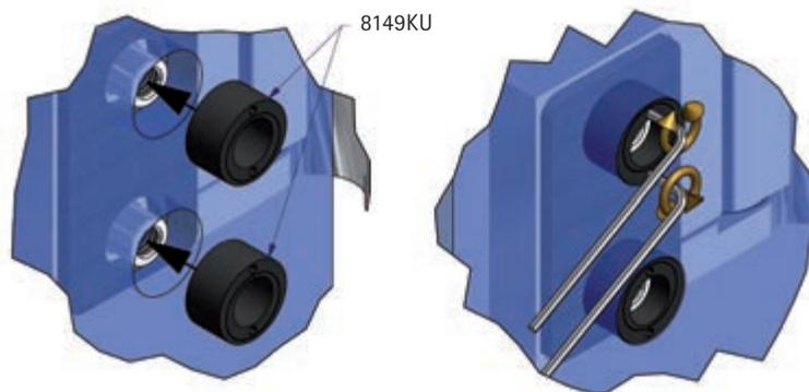
Durch den Einbau des Doppelexzentereinsatzes kann das Glas besser zentriert und dauerhaft positioniert werden.
