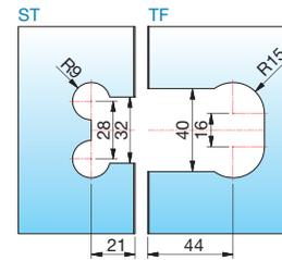
Glasbearbeitung für 8 mm ohne Dichtprofil
